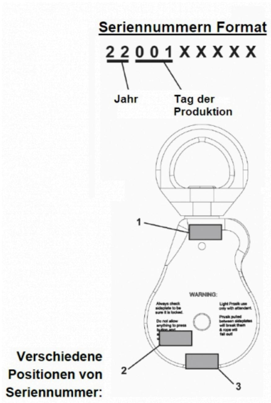
c) Fällt die **Seriennummer auf oder in den Bereich von 20050xxx bis 22304xxx**, dann unterliegt Ihr Omni-Block diesem Rückruf und muss an rock exotica [zurückgeschickt](#) werden.
