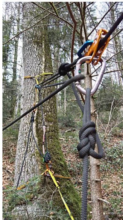
Zwei 1:2 Flaschenzüge zur Seilspannung ohne Verwendung einer Astgabel
