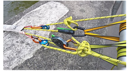
Zwei simple 1:2 Flaschenzüge für eine Doppelseilbrücke unter einer Brücke
