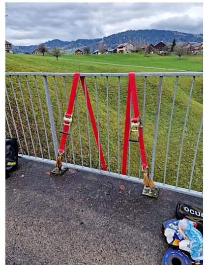
Lkw-Spanngurte als Seilbrücke ohne Durchhang unter einer Brücke (Ellington-Flaschenzug)
