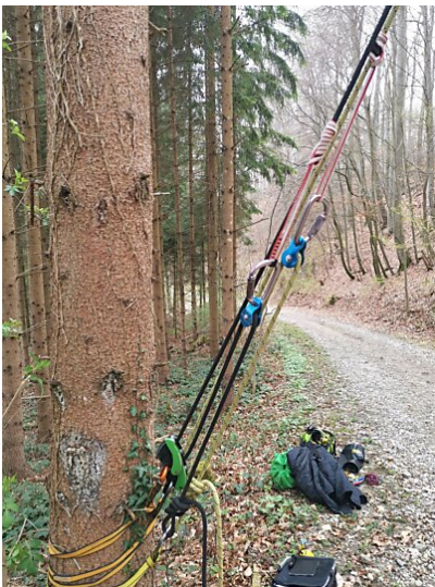
Zwei 1:2 Flaschenzüge zum Spannen einer doppelten Schrägseilbrücke
