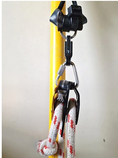
Doppelrolle mit Trigger
