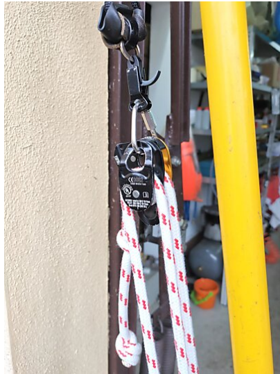
Rolle mit Trigger
