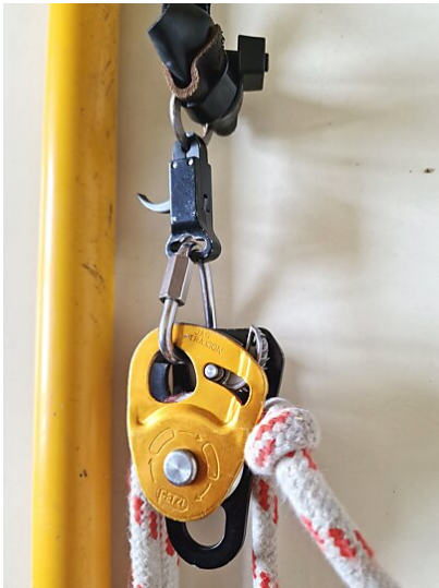
Doppelrolle mit Rücklaufsperre
